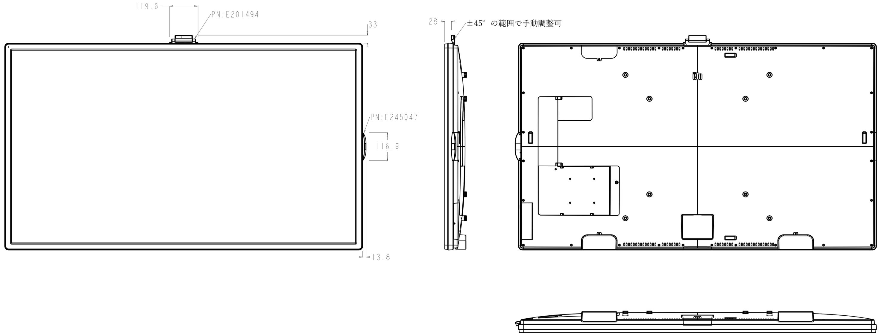
赤外線方式ET6553L-9UWA-1-MT-GY-Gの背面にAndroid Box PC E393359を取り付けた場合
