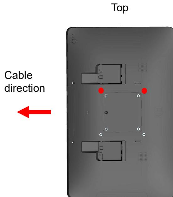
bag “L” のネジ2本(赤表示)を用いてVESAマウントの2か所に3mm程度浮かせてネジを取り付ける。
