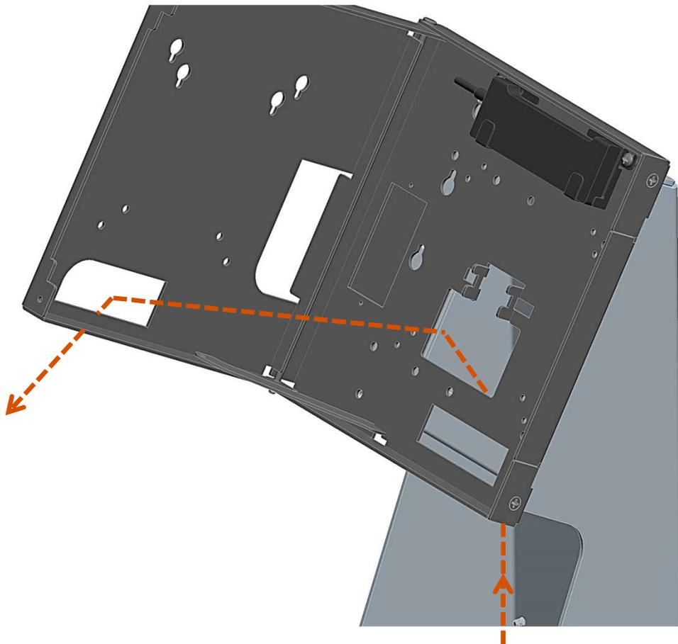
iシリーズ 用ACアダプタのDC電源ケーブルを図のように引き回す。
