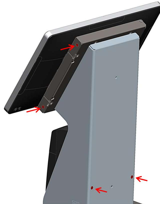
ディスプレイブラケットを閉じ、ネジ2本(赤表示)で固定し、ネジ2本で(赤表示)でプリンター部を背面から固定する。
