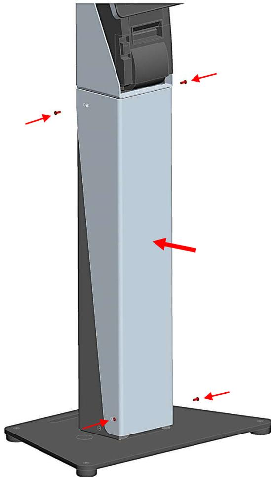
フロントカバーを取り付け、ネジ4本(赤表示)で固定する。
