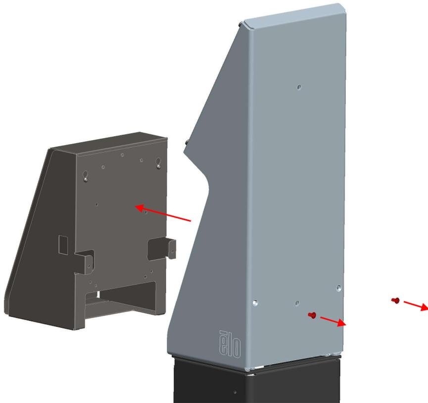
背面のネジ2本(赤表示)を取り外して、プリンタートレイを外す。
