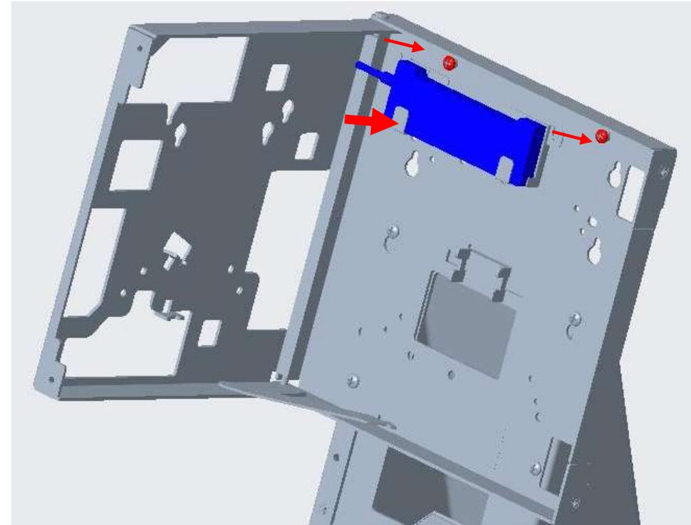
bag “S”のネジ2本(赤表示)を用いてUSB Hubを取り付ける。
