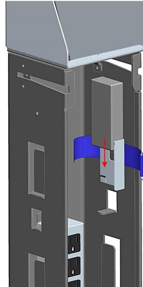
同梱のストラップを利用して、ACアダプタなどを取り付ける。
