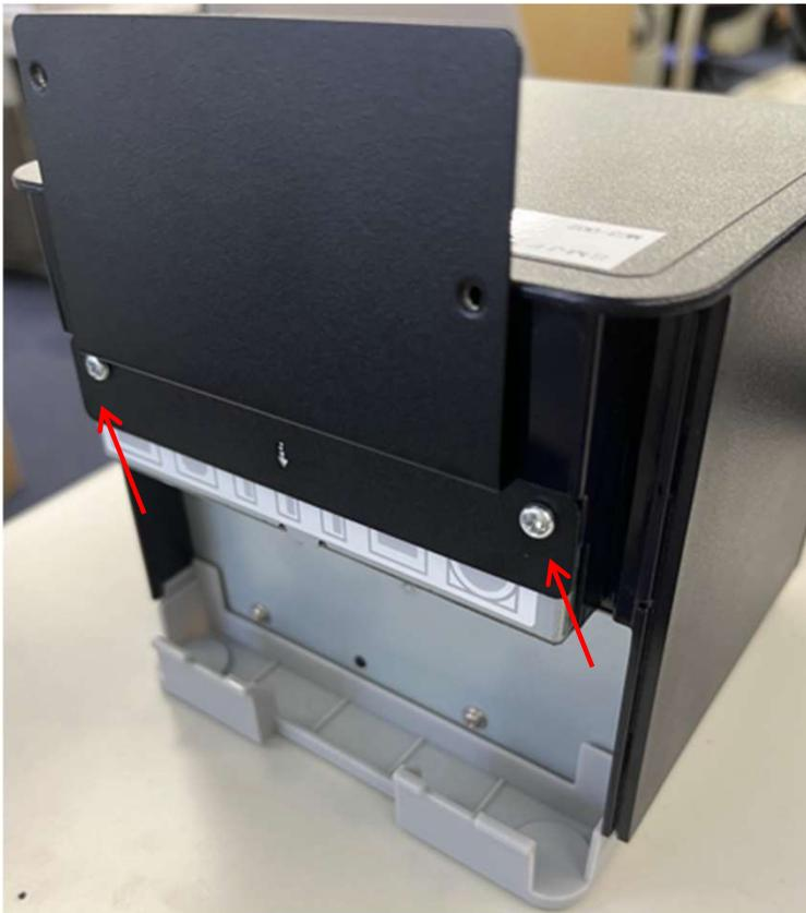
プリンター背面に、取り付けブラケットをネジ止めする。
