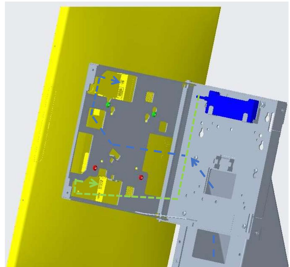
iシリーズのIO部のカバーを外し、iシリーズ2か所のネジ(緑表示)をブラケットの上の穴に引っ掛け、bag “L” のネジ2本(赤表示)を用いて、VESAマウント部に固定する。
