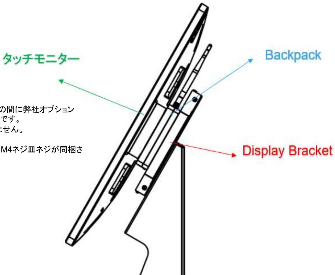
タッチモニターの場合、モニターとディスプレイブラケットの間に弊社オプション Android Box PC(PN:E393359)を取り付けることも可能です。但し、そのための長さ30mmのM4ネジは同梱されていません。
