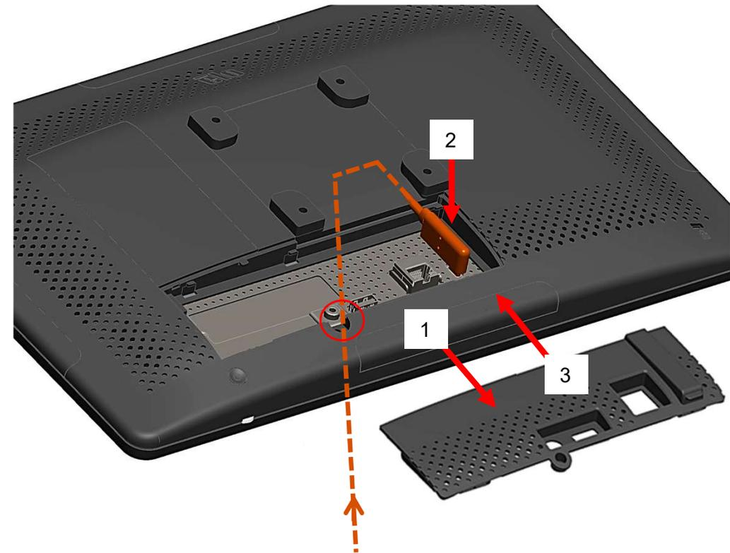
ケーブルカバーを外した状態で、ACアダプタのプラグを差し込み、再度ケーブルカバーを取り付ける。その際、DC電源ケーブルは図の○の位置から引き出す。
