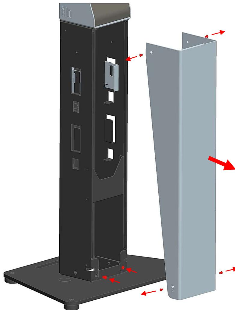
フロントカバーのネジ4本(赤表示)を外して、フロントカバーを取り外す。
