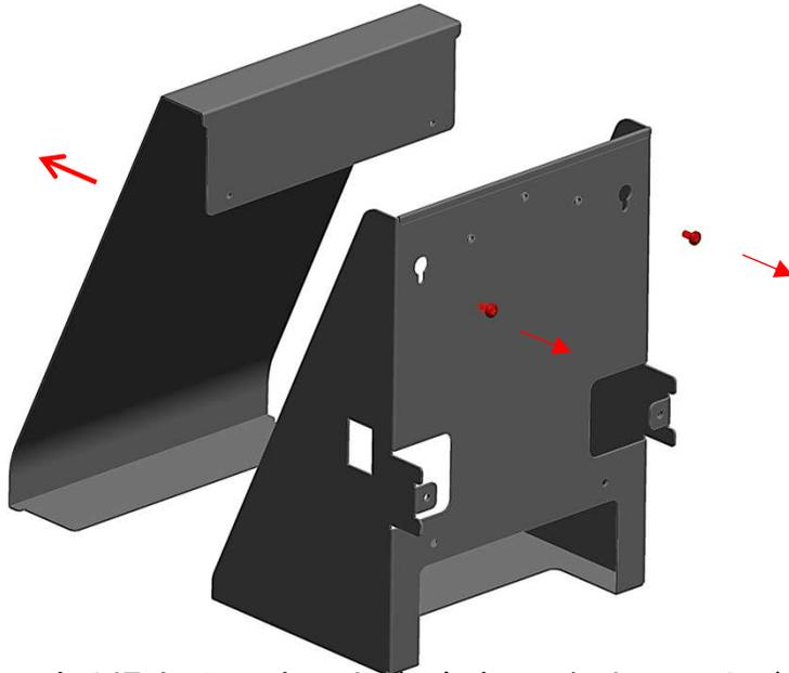
プリンターを使用する場合は、2本のネジ(赤表示)を外して、カバーを外す。
